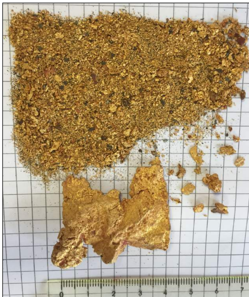
Figure 16 : Résultat d'un test de lavage "gros volume" sur les éluvions
