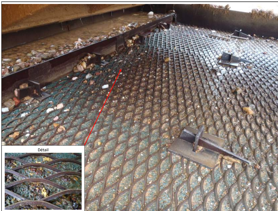
Figure 23 : Récupération de l'or sur métal déployé et sur moquettes 3M
