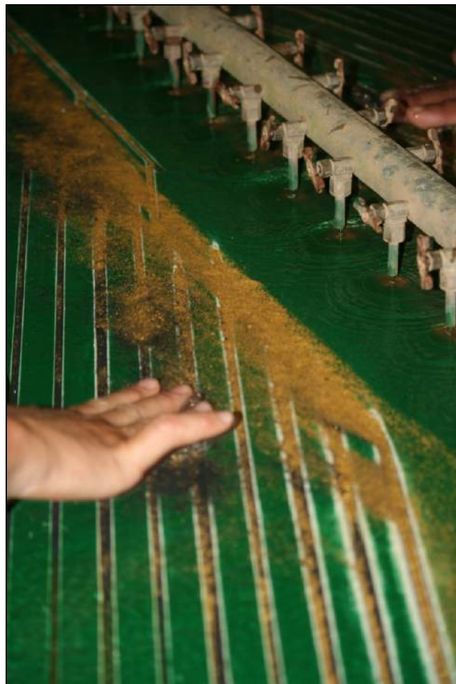
Figure 26 : Récupération de l'or sur la table à secousse
