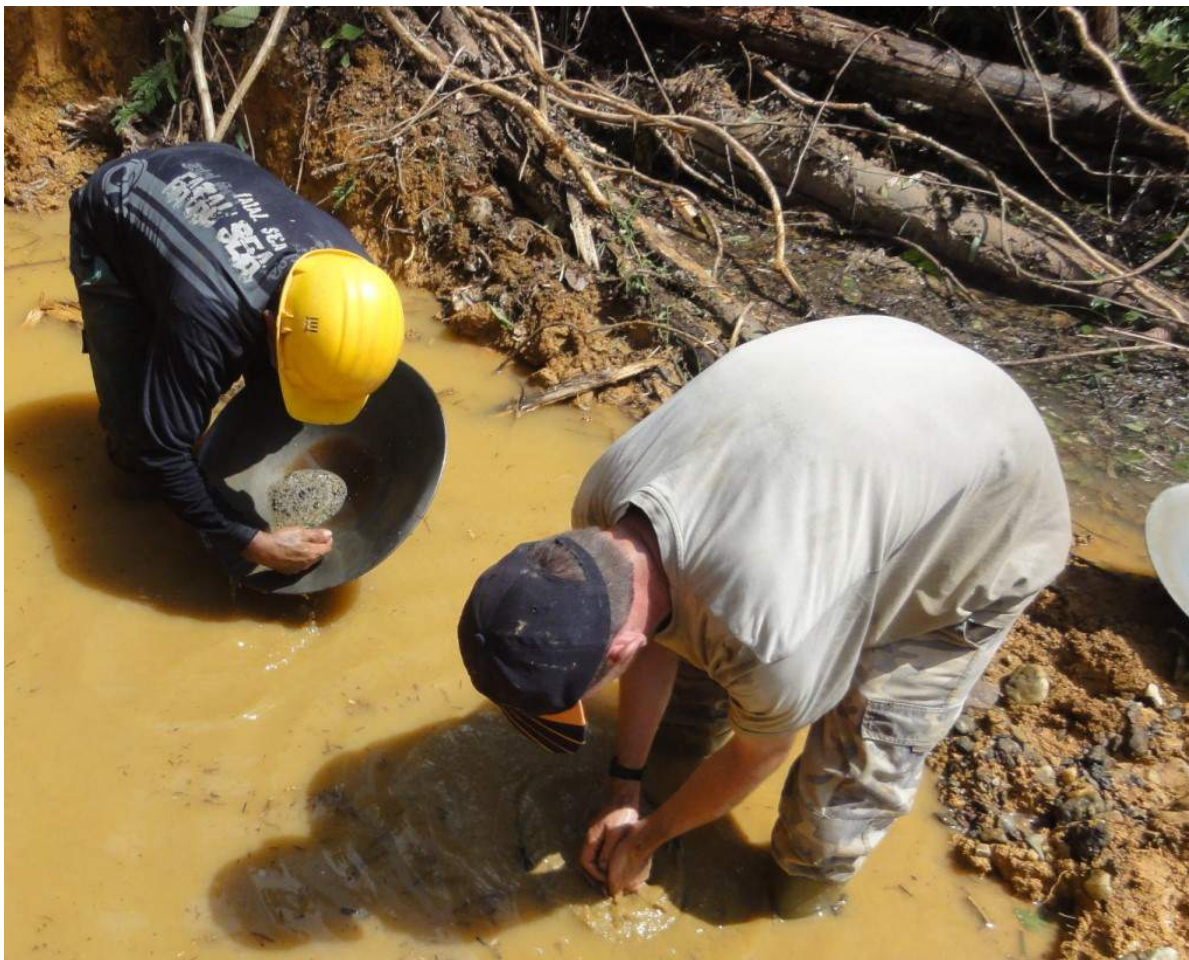
Figure 6 : Lavage des trois échantillons à la battée
